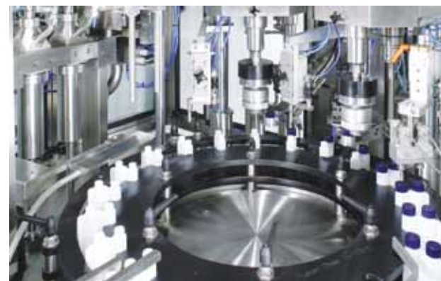
Servoantriebene Kolbendosierung und Unterspiegelfülldüsen, 2 Verschleißstationen, N 2 -Begasung und Endkontrolle
