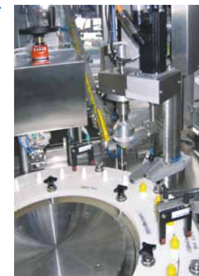
Keramik-Drehkolben, angetrieben durch 2 getrennte Servomotore
