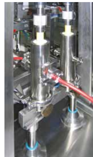
Keramik-Drehkolben, angetrieben durch 2 getrennte Servomotore
