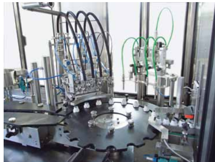
WFM 4/200 ATEX-Design* Abfüllung von Isocyanat Klebstoff Filling of Isocyanate adhesive*
